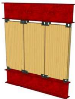
CLT制震壁イメージ図(左)とセンターでの試験風景(右)
